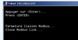
4. L'ANL48 clôt la connexion de communication Modbus TCP avant d'entrer en mode configuration.
